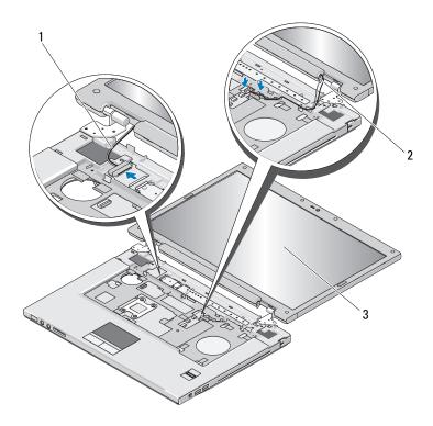
1 display cable 2 antenna cables
